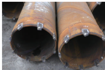
写真1. 先端超硬ビット取付鋼管杭
