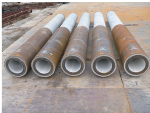
写真-1 新しい評定杭 (SPHC杭)
