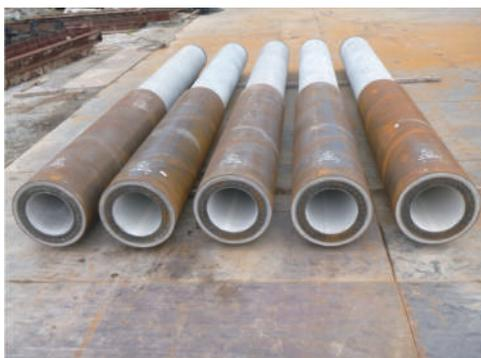
写真-2 新しい評定杭 (SPHC杭)
